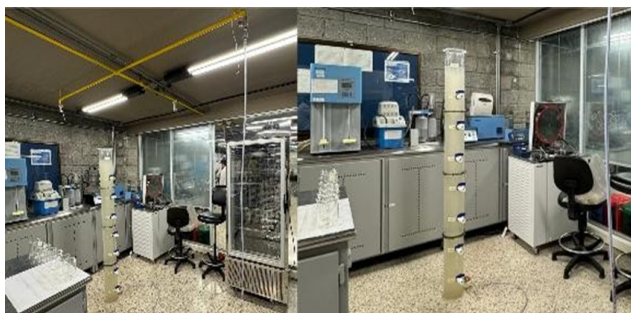
Figura. 3. Montaje torre de sedimentación.
