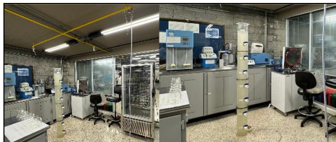
Fig. 3. Montaje torre de sedimentación.
