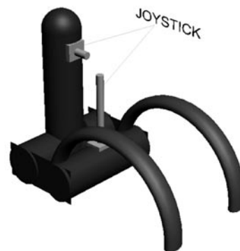
Figura 2. Ubicación de Joystick análogos para la detección de los movimientos de la cabeza. Fuente: los autores, 2009
